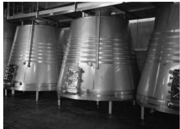
Depósitos troncocónicos de acero inoxidable con descube manual.
