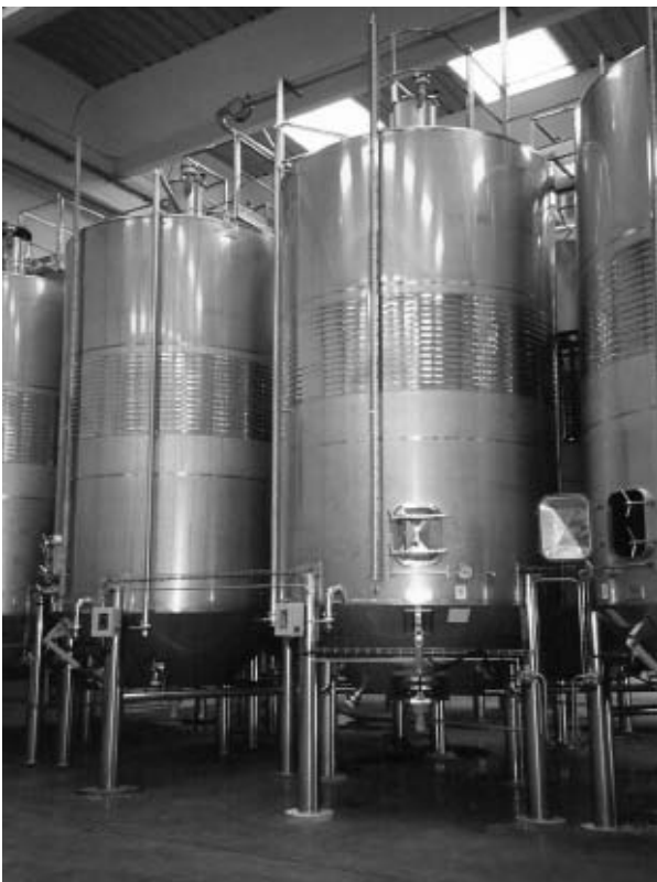
Depósitos de acero inoxidable autovaciantes sobre patas.
