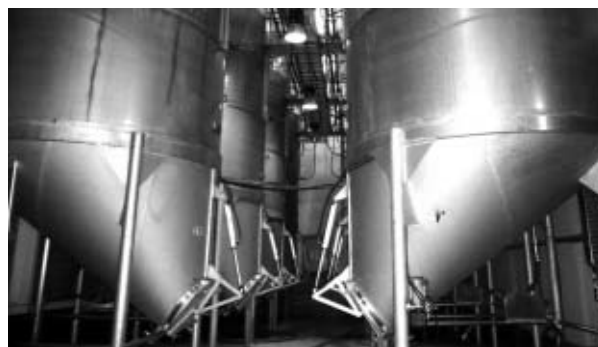
Depósitos autovaciantes de acero inoxidable con descube controlado irregular.
