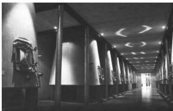
Batería de depósitos de hormigón troncocónicos 26 %, de 30 a 100 hl (Nomblot).
