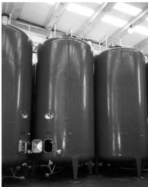
Depósitos de acero al carbono sobre patas revestidos interiormente con esmalte vitrificado.
